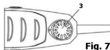
L'impostazione ottimale varia a seconda del tipo di accessorio che si deve usare, del materiale da lavorare e dalla complessità del progetto. Si consiglia di fare una prova su un pezzo di materiale di scarto e di partire dall'impostazione più bassa. Nella tabella qui di seguito si possono trovare alcune raccomandazioni.
